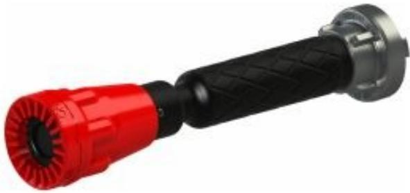
Durch Drehen des Gummikopfes im Uhrzeigersinn stufenlos von Absperrung über Sprühstrahl von 120° auf Vollstrahl kontinuierlich leicht einstellbar. Die Sprühzähne mit innenseitig flachen Umlenkungsflächen erzeugen einen im Zentrum vorwärtsgerichteten Sprühnebel. Daraus resultiert eine große Wurfweite des Sprühstrahls.
